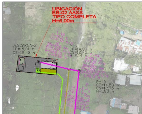
Imagen 02: Estación de Bombeo #2 tipo Principal - Brisas del Pacífico.
