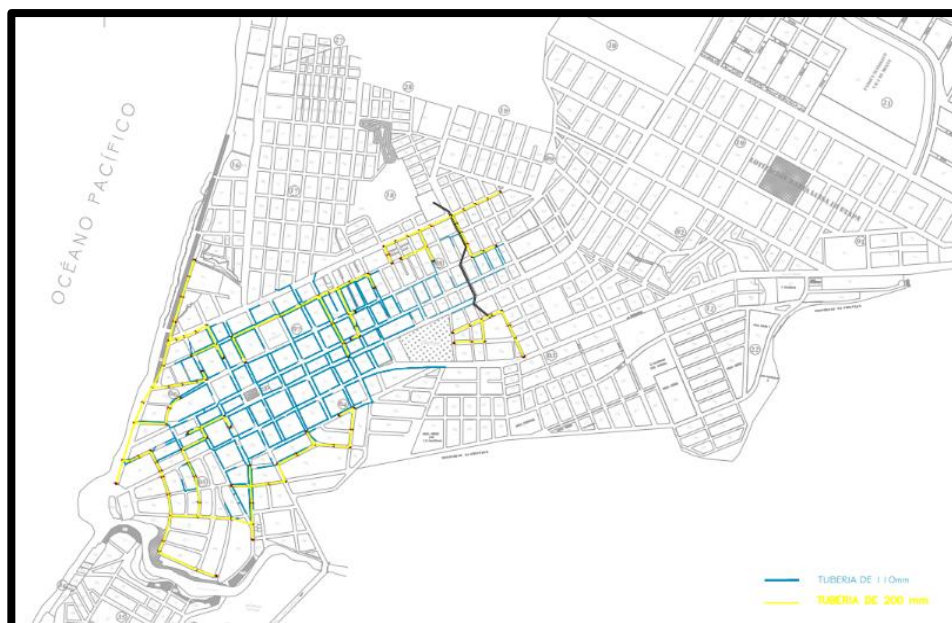
Imagen 3: Cobertura 20% y Esquema de Redes Afectadas Post Terremoto - Ciudad de Pedernales.
